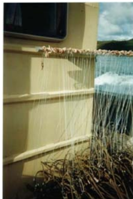
Figure n°4 : fixation des avançons et préparation du rail de filage de la palangre
