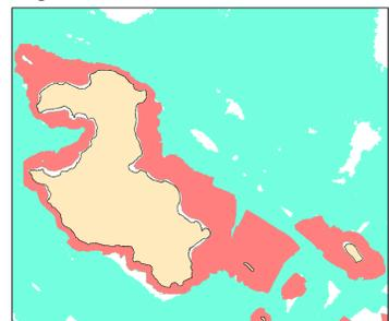
**BATHYMETRIE:** données acquises à l'aide du Sondeur Multifaisceaux SIMRAD EM1002 du Navire Océanographique l'ALIS (IRD) et à l'aide du sondeur SIMRAD EM12 de l'Atalante (IFREMER) ont été utilisées pour cette carte.
