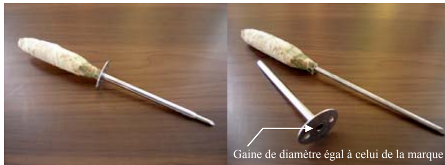
Figure 9. Trocart utilisé pour l'implantation intra musculaire des marques acoustique.
