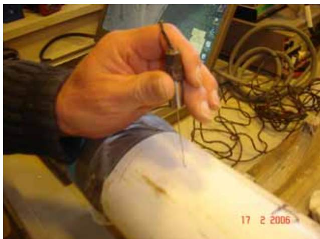
Figure 3. Mesure de la conductivité thermique en laboratoire sur les carottes prélevées par la méthode du fil chauffant. La sonde de mesure est insérée dans le sédiment à travers des trous percés dans la chemise de la carotte tous les 25 cm.
