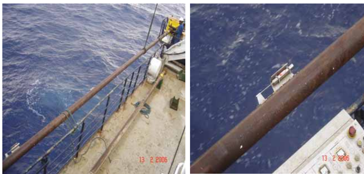
Figure 1 : Carottier gravitaire FLUX du Marion Dufresne. La thermistance utilisée pour la mesure de la température est positionnée à mi-longueur du tube fin de la sonde thermique qui vient en contact avec le sédiment (photo de droite). L'électronique de mesure et la mémoire sont contenues dans le boîtier cylindrique prolongeant ce tube. Les sondes thermiques ainsi constituées sont fixées sur des supports qui les maintiennent à 7 cm de la paroi du carottier afin d'éviter au cours de la mesure de la température du sédiment la perturbation thermique propagée depuis la paroi externe du carottier. Les supports sont soudés en hélice autour du tube du carottier (photo de gauche).
