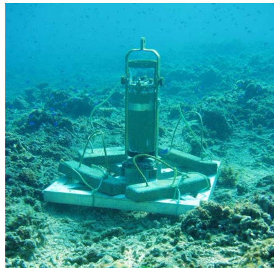
Figure II-8 Le houlomètre Aanderaa WTR9 en opération
