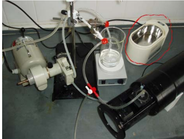
Figure II-7 Dispositif de mesure à l'aide du LISST en laboratoire.
