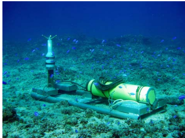
Figure II-10 La sonde Sontek ADVOcean en opération
