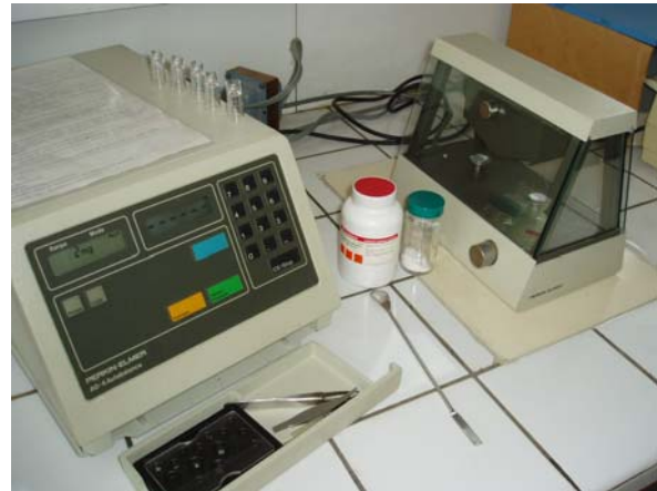
Figure II-4 Perkin-Elmer AD-4 Autobalance: précision de 0.001 mg.
