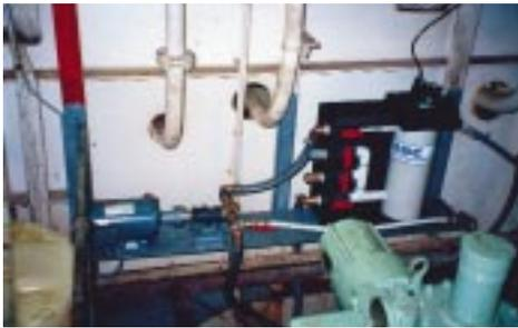
Thermosalinographe installé à la salle des machines d'un navire de commerce. Les données de température et de salinité ainsi que la position GPS sont enregistrées à la passerelle sur un PC portable. Actuellement, six navires traversant la zone économique de Nouvelle-Calédonie sont équipés de thermosalinographes.
