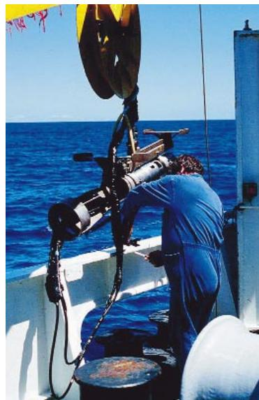
Préparation du canon à air utilisé pour les tirs sismiques. Ce canon est rempli d'air comprimé à une pression variant de 70 à 210 bars. Le relâchement de cet air toutes les dix secondes provoque une explosion engendrant une onde acoustique qui, d'une part se réfléchit sur le fond marin, d'autre part pénètre les différentes couches constituant le substratum. L'enregistrement des signaux réfléchis fournit une coupe géologique de la zone.
