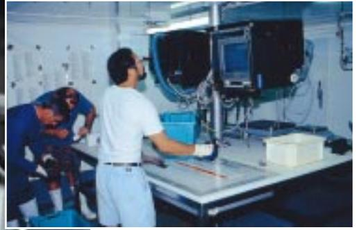
A bord du *Tangaroa*, mesure automatique de longueurs de poissons à l'aide d'une règle électronique. Les données recueillies sont stockées dans le réseau informatique centralisé du bord.
