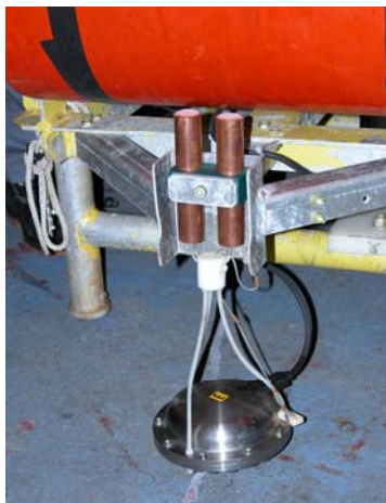
Fig. V.1.2 : Vue de détail de la gamelle contenant le géophone (conception Tim Owen, Université de Cambridge). Lorsque l'OBS arrive au fond, le géophone est libéré de son support par électrolyse de façon à reposer sur le sol
