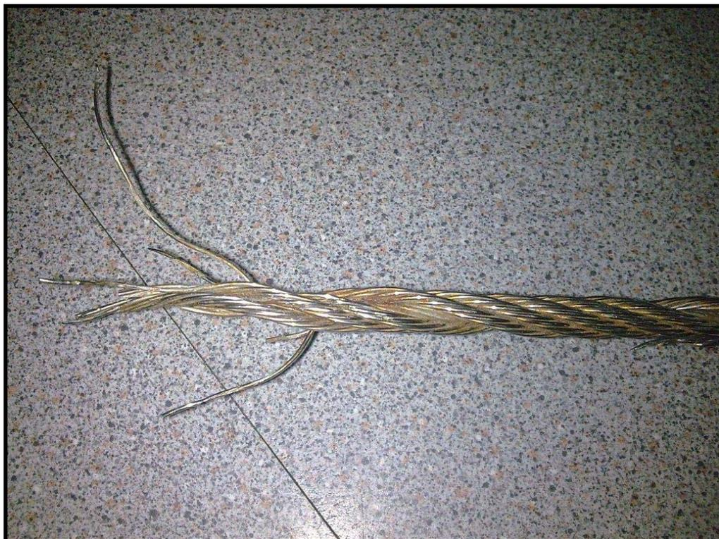
***Câble inox d'un DCP ayant rompu suite à un phénomène de corrosion électrolytique***
