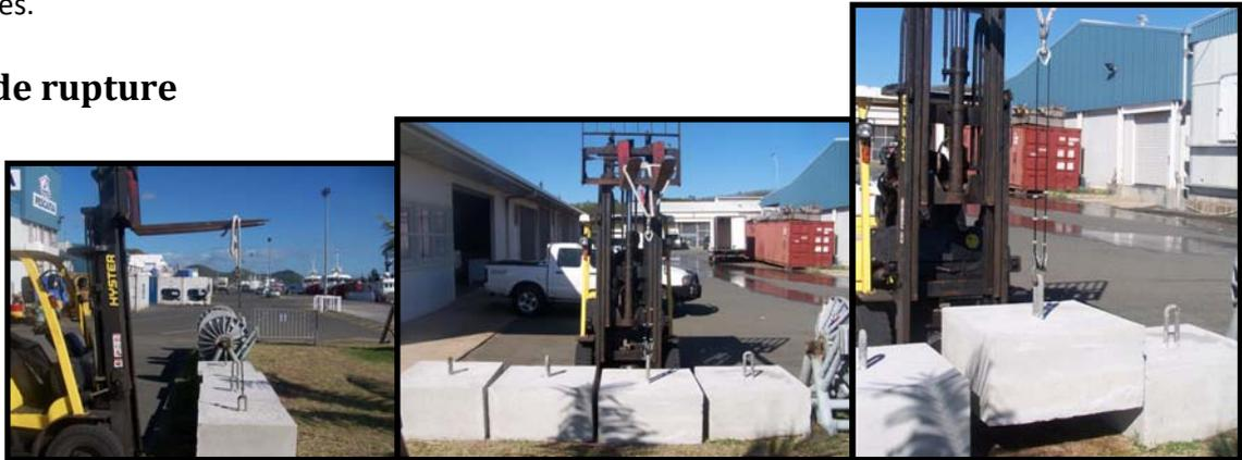
*Le hissage d'un corps mort de 700 kg a été concluant, le nylon affichant une résistance de 1300 kg n'a pas rompu.*
