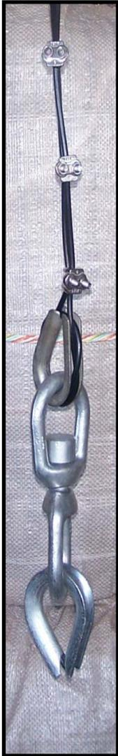
L'emploi d'un nouveau matériau a nécessité une réflexion sur la réalisation de connexions fiables et adaptées pour relier la partie supérieure du nylon à la filière de bouées, et la partie inférieure au cordage polypropylène tout en respectant le type de montage classique habituellement mis en œuvre.
