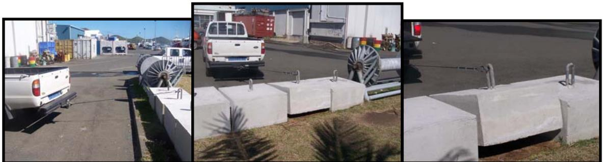
*La traction d'un corps mort d'un tonne jusqu'à son soulèvement n'a entraîné aucun étirement du nylon, ni rupture de la connexion.*
