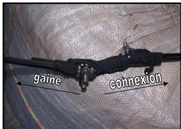
Afin d'éviter que la gaine n'emprisonne de l'air lors de la mise à l'eau du dispositif, des trous sont effectués dans sa partie haute.
