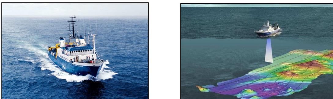
**Figure 18: à gauche : le navire océanographique australien *Southern Surveyor*. A droite : schéma d'un levé bathymétrique multifaisceaux.**
