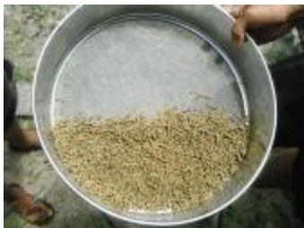
L'aliment est déposé dans un tamis afin d'être mis en étuve pour être déshydraté.
