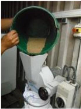
Verser la quantité d'aliment souhaitée dans l'entonnoir du broyeur.
