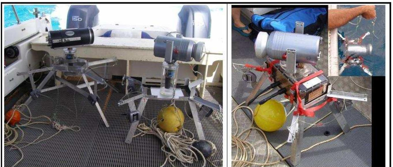
**Supports.** Deux structures métalliques construites par Nicaise Daffond (Atelier IRD Nouméa) ont été utilisées pour assurer une stabilité à l'ensemble au fond de l'eau tout en élevant l'angle de vue. Des bras ont été rajoutés afin d'y fixer le système de largage (Figure 14) et des plombs pour abaisser le centre de gravité du tout.
