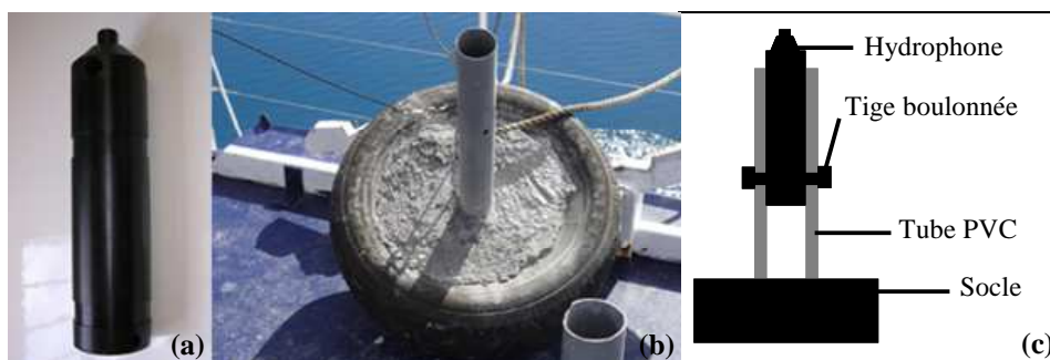
Fig. 11. Hydrophone VR2 (a), système d’ancrage sur le substrat (b) et schéma du dispositif monté (c).
