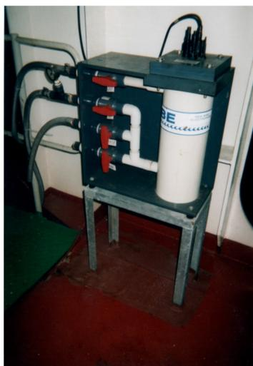
Les thermosalinographes (modèle SEA-BIRD SBE16, photo ci-contre) sont des appareils qui mesurent la température et la conductivité (et donc la salinité) de la mer en continu. Deux appareils sont utilisés dans ce réseau de mesures, un appareil acheté par l'IRD et un appareil acheté en 1994 grâce au programme ZoNeCo. Ils sont calibrés une fois par an chez le constructeur à Seattle (Etats-Unis).
