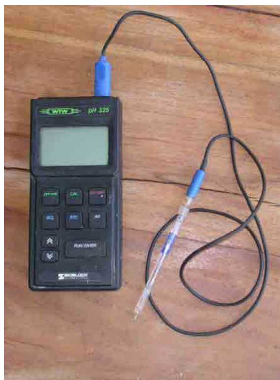
Figures 2 et 3 : pHmètre et pH/mvmètre utilisés pour les mesures de terrain en octobre 2004.
